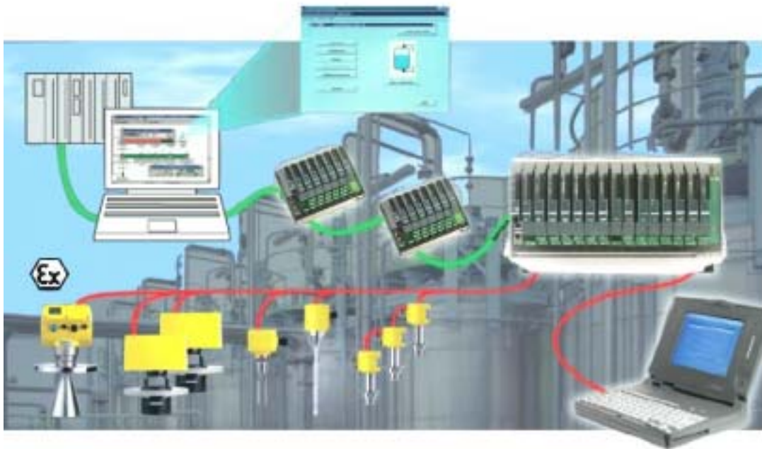
应用雷达式物位传感器的 AI OS2500DCS 控制系统示意图
